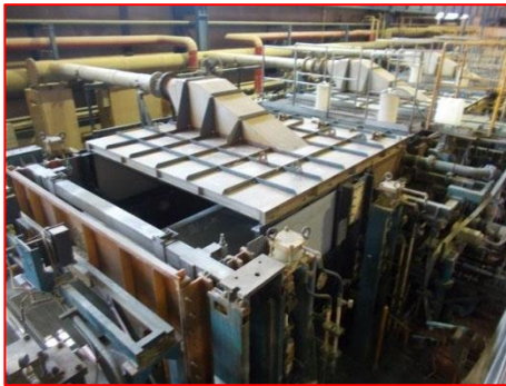
- ฝาครอบบ่อในส่วนของการเคลือบสังกะสี
